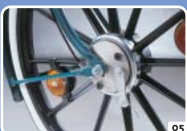
frein à tambour, intégré à l'axe de la roue avant
