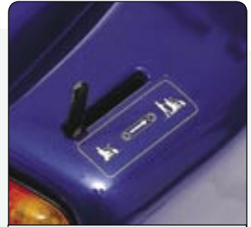
Levier de débrayage Débloquez le frein moteur pour déplacer le scooter manuellement
